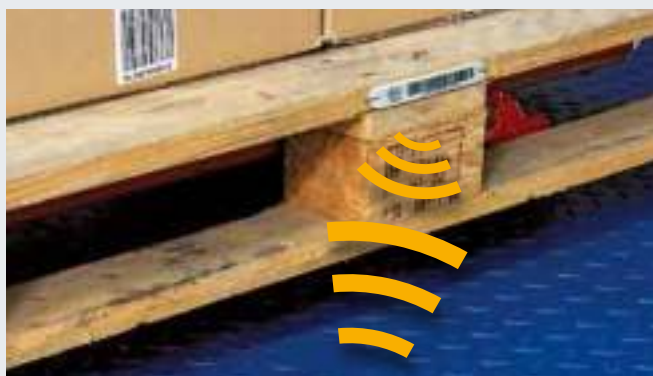
Betrouwbare gegevensoverdracht langs de kortste weg tussen RFID-transponder en leestoestel.
